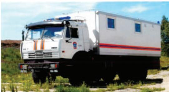
Автомобиль предназначен для обеспечения оперативной связи и управления, работы и отдыха расчета, перевозки расчета из 7 человек, перевозки специального оборудования и инструмента, буксировки прицепа с оборудованием для первоочередного обеспечения пострадавшего населения при возникновении чрезвычайных ситуаций.
